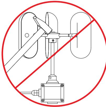
Evitar impactos em qualquer parte do equipamento.
