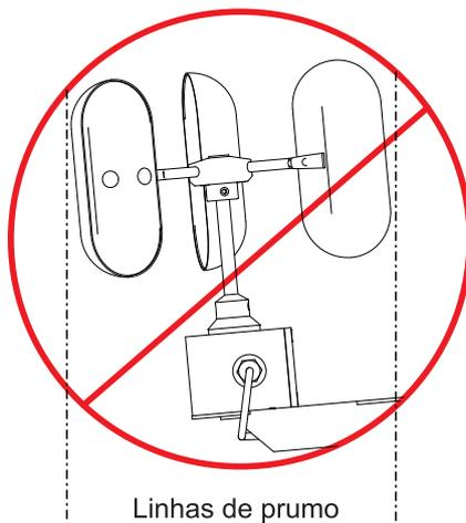
Nunca instale a unidade sensora com as pás inclinadas em qualquer sentido
