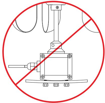
Nunca instale em uma base irregular ou com furos acima de Ø5,5 mm.
